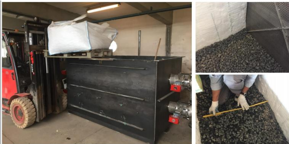
Slika 37. Sustav visokotemperaturne pohrane u sloju kamena
